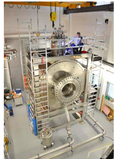
Hochfeldmagnet am Helmholtz-Zentrum Berlin. Mit 25 Tesla liefert er weltweit das stärkste Magnetfeld im Zusammenhang mit Neutronenstreuexperimenten.
