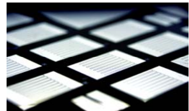
Kammförmig ineinandergreifende Metallkontakte auf der sonnenabgewandten Seite der Rückseitensolarzellen mit Siliziumheterokontakten. Zu sehen sind mehrere Testzellen auf einem Siliziumwafer.
