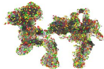
Darstellung der Katalysator-Nanopartikel: Die Partikel (farbig) haften an einem Trägermaterial (grau). Sie werden mit der Elektronentomographie erfasst. Für die Darstellung werden die Daten mit neuen Verarbeitungsalgorithmen bearbeitet.
