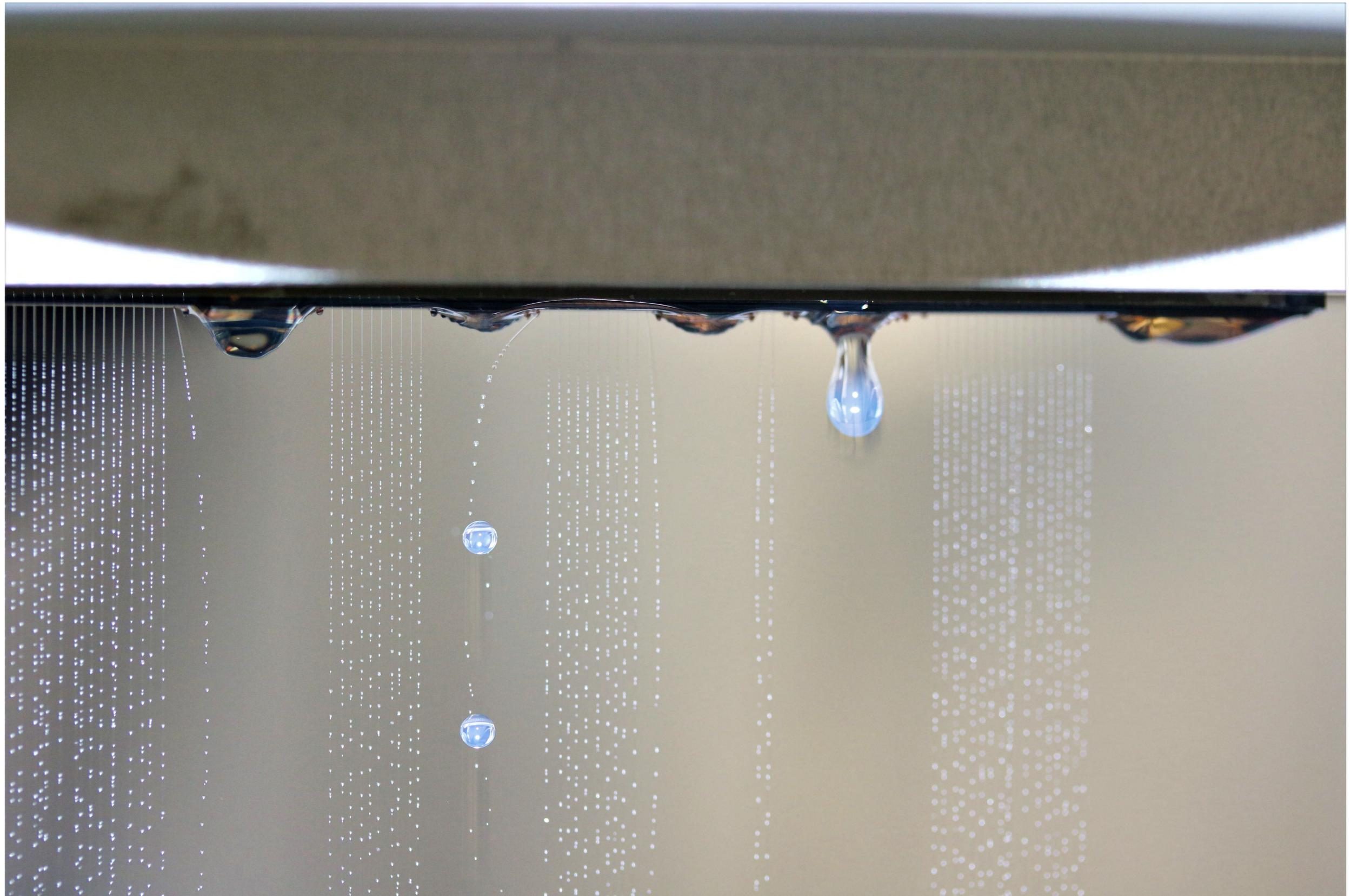
Reinigung eines Tintenstrahl-Druckkopfs nach dem Druck.
