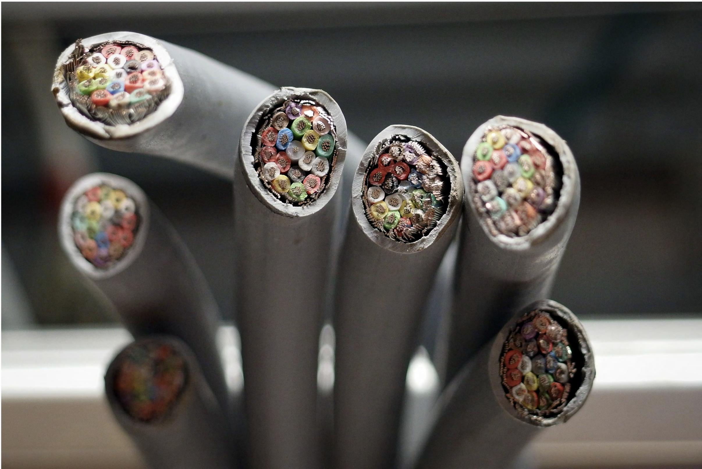
Durchtrennte Kabelstränge beim Abbau der TBR (Trockenbestrahlungsvorrichtung am Reflektorrand).
