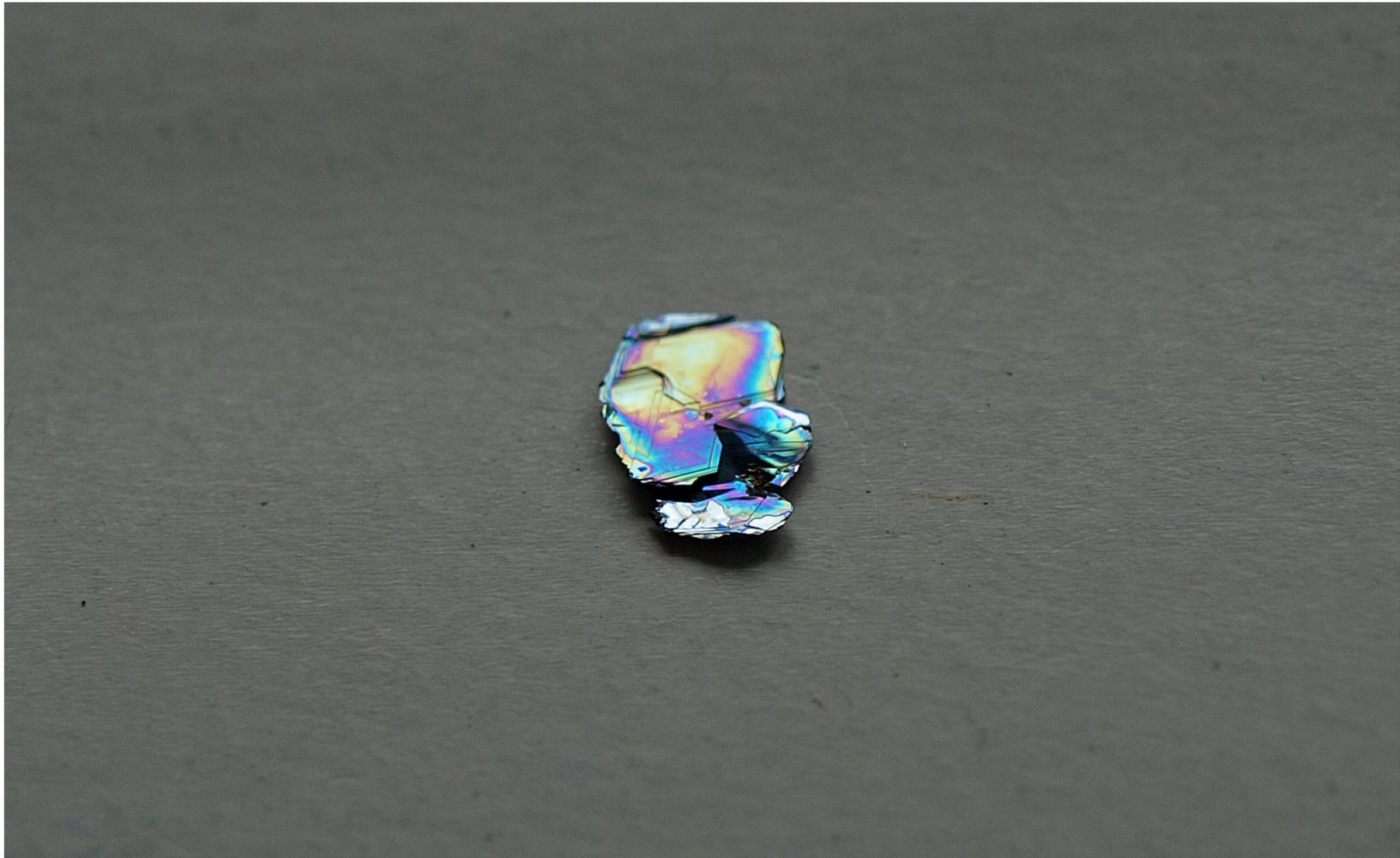
Regenbogen in einer Probe - Dieses Bild zeigt einen Einkristall, d.h. einen Kristall, der über seine gesamte Größe ein einziges Strukturmuster aufweist. Das Nahaufnahme-Bild enthüllt weitere Details des Kristalls: Er besteht aus flachen, durch Stufen getrennten Ebenen, die Stufen begrenzenden Winkel sind genau  $60^\circ$ , was auf eine hexagonale Symmetrie hinweist, und der größte Teil der Oberfläche zeigt die Farben des Regenbogens, bedingt durch die Interferenz des Sonnenlichts.
