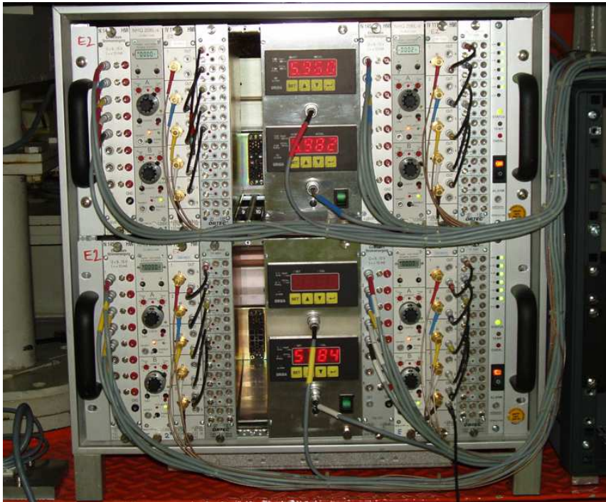
Abbildung 3.6: Detektor-Verstärkerelektronik mit Hochspannungsversorgung und Anzeigen für die Überwachung des Detektorinnendrucks.
