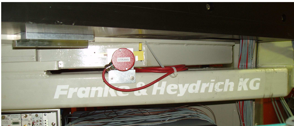
Abbildung 2.14: Die Translationsachse für das Detektorgehäuse. Oben ist der Antrieb mit Getriebe zu sehen und unten die Schienen mit Encoder.
