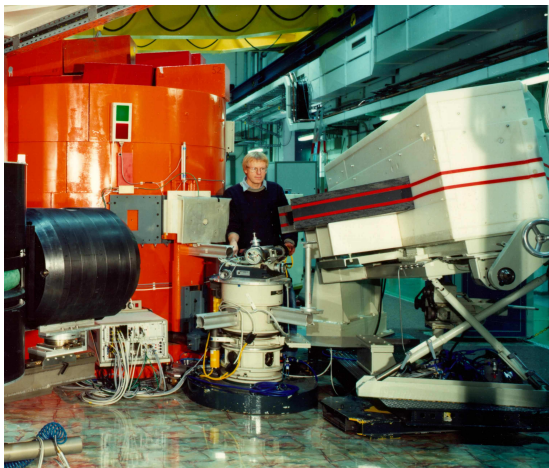
Abbildung 1.1: Das Flat-Cone-Diffraktometer der 80er Jahre hat noch keinen Radialkollimator. Rechts daneben der neue E2 Aufbau in einem frühen Stadium des Umbaus.
