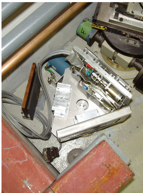
Abbildung 2.2: a) Auf der linken Seite ist der Kollimatorwechsler zu sehen mit den 30° und 15° Kollimatoren. b) Das rechte Bild zeigt den auf den Kopf gelegten Monochromatorwechsler mit den Monochromatoren aus Kupfer, Germanium und Graphit.
