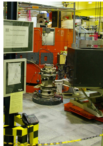
Abbildung 1.1: Das Flat-Cone-Diffraktometer der 80er Jahre hat noch keinen Radialkollimator. Rechts daneben der neue E2 Aufbau in einem frühen Stadium des Umbaus.
