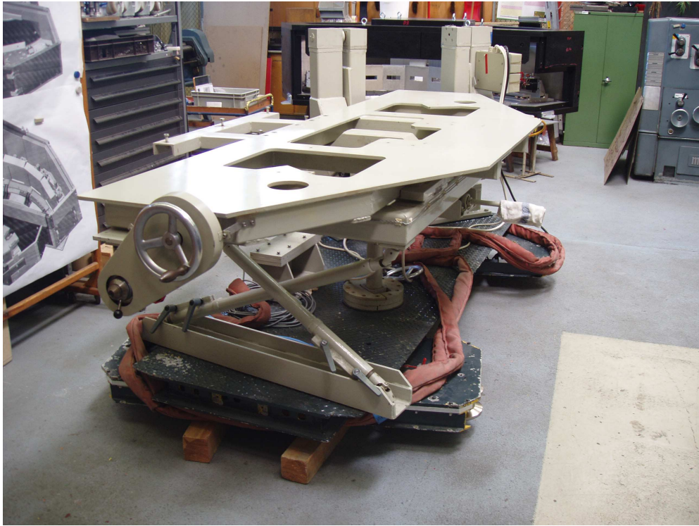
Abbildung 5.3: Der Unterbau des Gehäuses. Es wurden die Encoder und die Motoren ausgetauscht.
