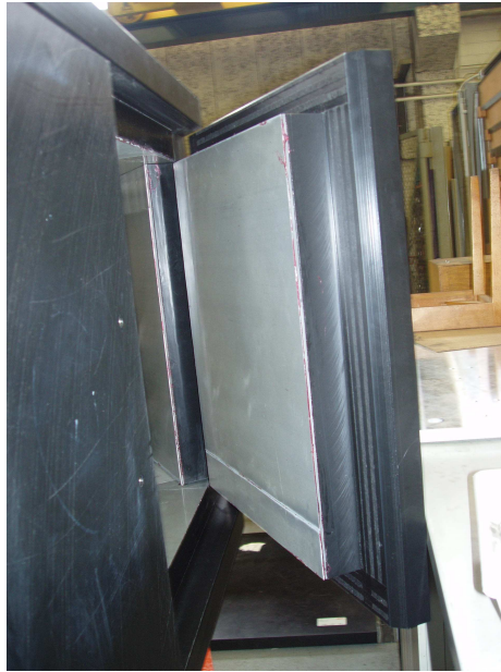
Abbildung 2.13: Die rückseitige Tür des Gehäuses. Es sind die verschiedenen Schichten der Abschirmung zu erkennen.
