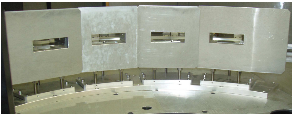
Abbildung 6.3: Halterungen für die horizontalen Kollimatoren welche für die Energieanalyse benötigt werden. Im integralen Betriebsmodus werden diese herausgenommen.
