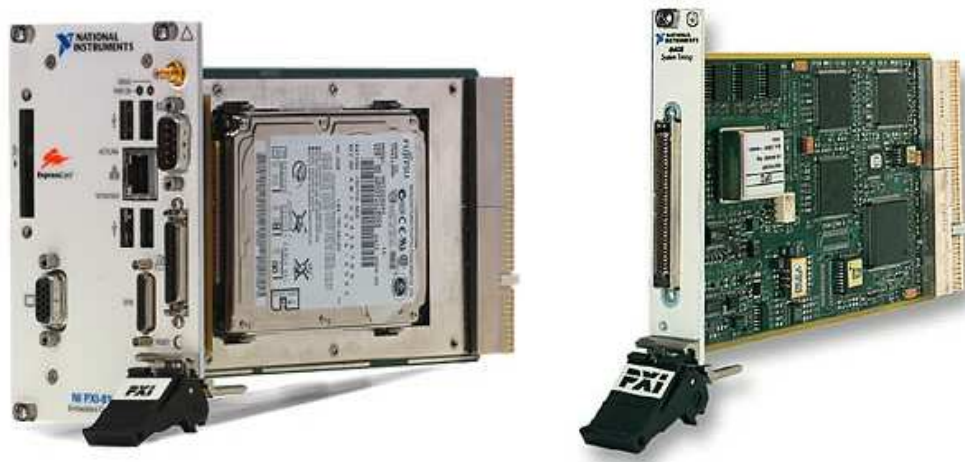
Abbildung 3.8: Rechner für ein PXI System (NI-8196) mit einer Counter-Karte (NI-6602) von National Instrument.
