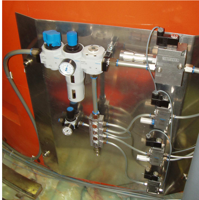
Abbildung 2.5: Neue elektrische Pneumatik-Verteilung.
