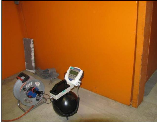
**Abbildung 9:** Neutronenmessung an Fässern mit Beryllium, die hinter einer Abschirmwand aus Stahl und Blei gelagert werden [HIE01].
