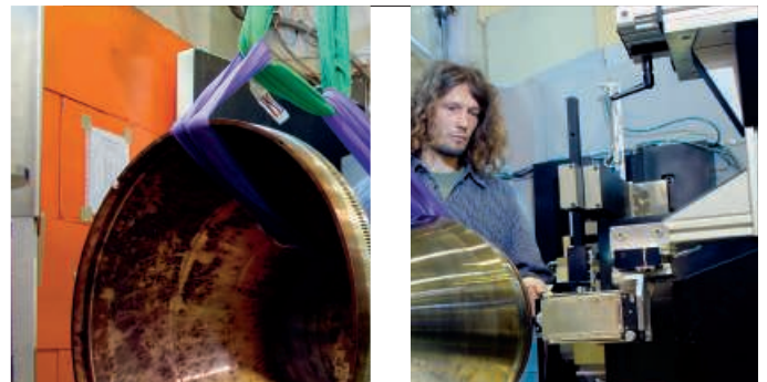
EIGENSPIGUNGSSANALYSE am Hahn-Meitner-Institut hilft, teure Bauteile – im Bild ein Teil einer Ariane-Rakete – auf unsichtbare Materialschäden zu untersuchen.
