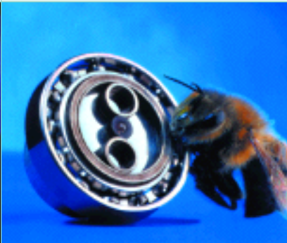
Mikrogetriebe hergestellt mit Hilfe von Synchrotronstrahlung
