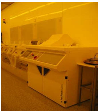
Abbildung 2: Fotos der im Reinraum installierten Technotrans Galvanikanlage microform.100
