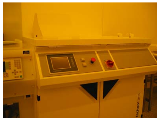
Abbildung 2: Fotos der im Reinraum installierten Technotrans Galvanikanlage microform.100
