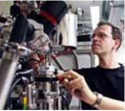
Messapparatur für spezifische Wärmekapazität an der die magnetischen Monopole 2009 erstmals nachgewiesen wurden.
